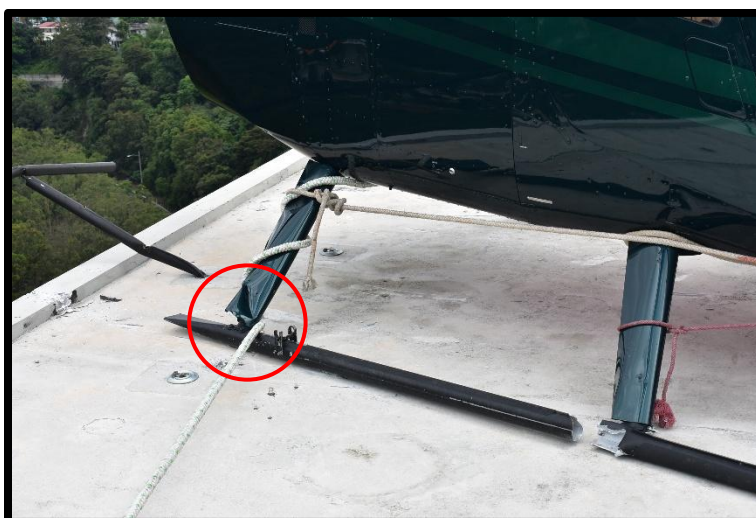
Fotografía No. 5 Vista del skid lado derecho posterior con daños.
