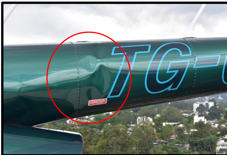
Fotografía No. 10 Vista de la corrugación en el botalón de cola.
