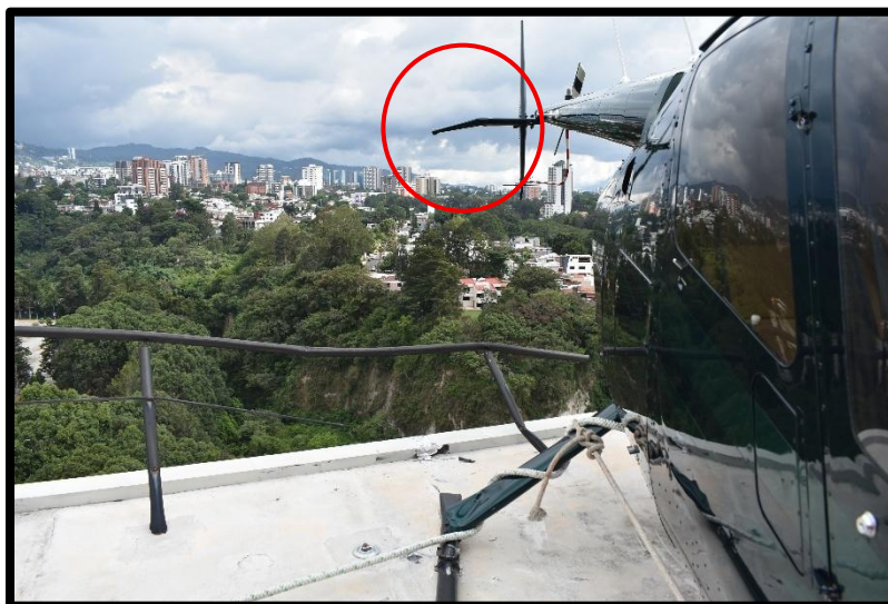
Fotografía No. 7 Vista del estabilizador vertical del rotor de cola deformado.
