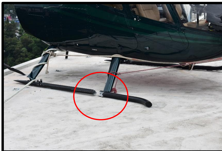
Fotografía No. 4 Vista del skid lado derecho fracturado.
