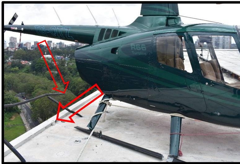
Fotografía No. 6 Vista del punto de impacto del skid con el borde de cemento y baranda de seguridad con daños.
